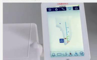
LOCALISATEUR D'APEX MANUEL Le localisateur d'apex peut également être utilisé en mode manuel, en connectant la sonde externe au panneau du praticien. En appuyant sur la touche dédiée dans le menu supérieur, l'écran affiche une barre colorée qui s'illumine progressivement et émet des signaux sonores pour indiquer l'approche de l'apex.
