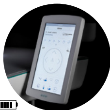
Indication du signal et de l'état des batteries sur l'écran Touch Expert Pro.
